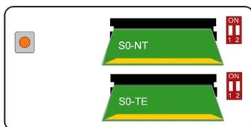
Abb. 13: Mini-Module zur ISDN-Anschlusskonfiguration und Reset-Taster
