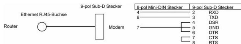
Abbildung 1-1: Spezifikation Kabel für die AUX-Schnittstelle zum Modem
