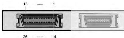
Fig. 30: X.21 interface (26-pole mini Delta ribbon socket)
